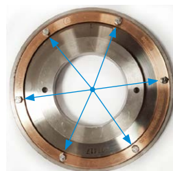
Fissare le viti con una coppia di 3.4Nm
